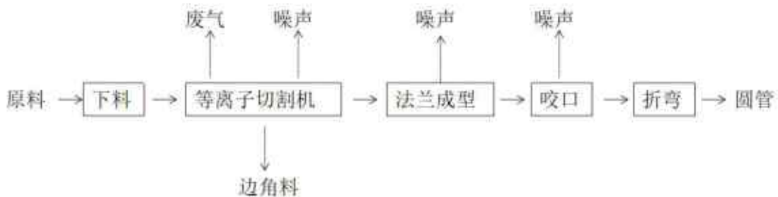
图 3 圆管工艺流程及产污环节图
